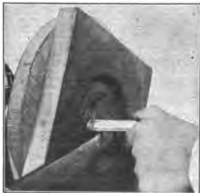
Fig. 232. Using Gouge on Frame.
